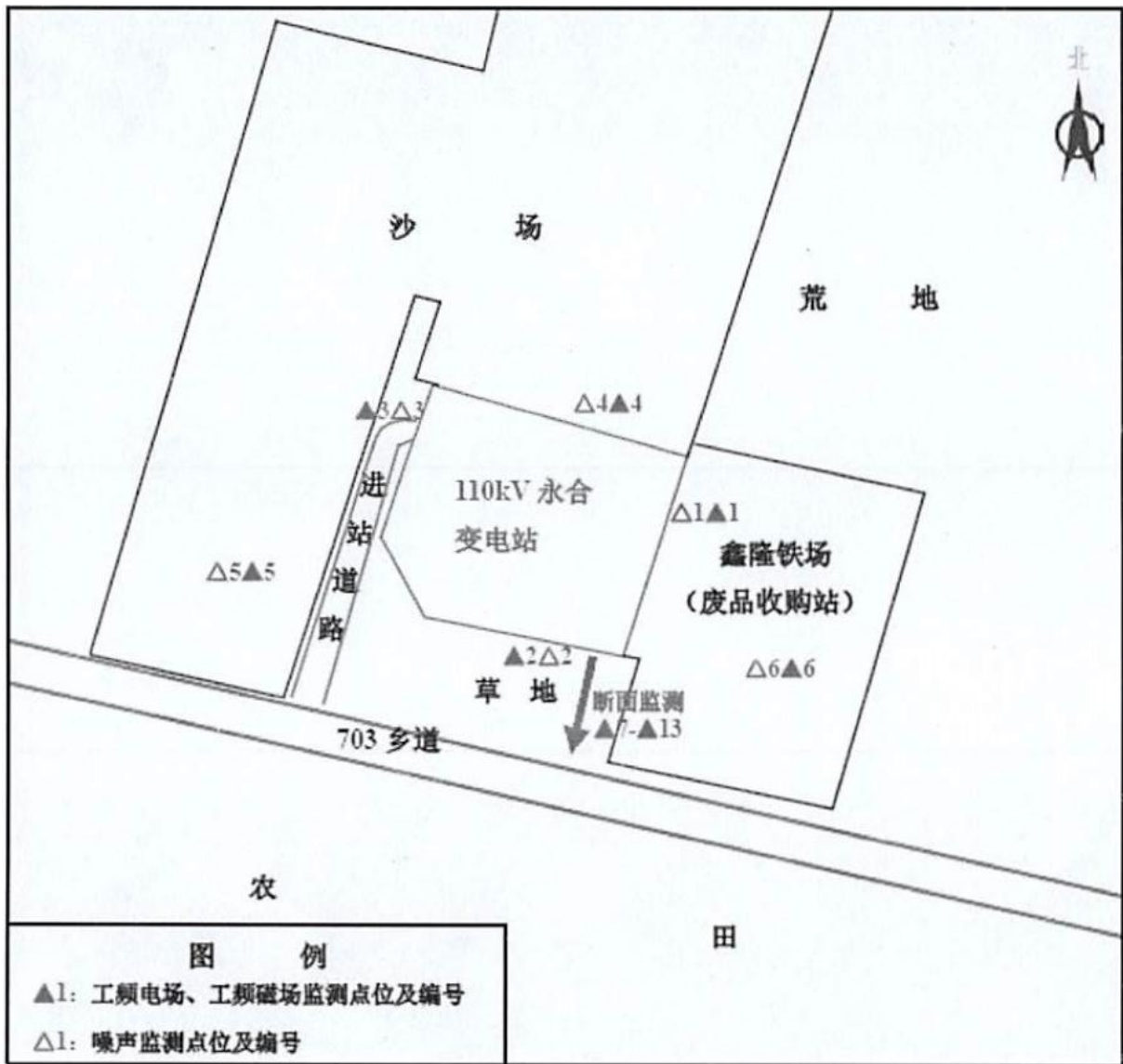
图 9-1 110kV 永合变电站监测布置图
